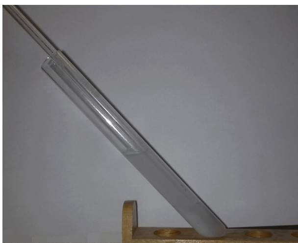
Slika 5 – Dokazivanje ugljikova(IV) oksida uvođenjem u vapnenu vodu
