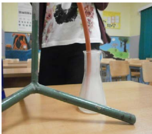
Slika 5 Erlenmeyerovala tikvica s uzorkom dobivenog dušikovog (I) oksida
