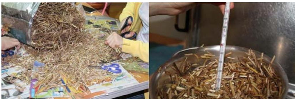
Slika 3 - Slamu je bilo potrebno nasjeckati na komadiće veličine oko 5cm; Pri kuhanju je bilo potrebno održavati slamu na stalnoj temperaturi 65 – 75°C
