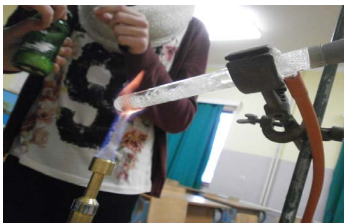
Slika 4 Dobivanje dušikovog (I) oksida termičkom razgradnjom amonijevog nitrata, \text{NH}_4\text{NO}_3
