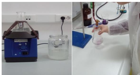
Slike 6 i 7 Homogeniziranje uzorka i određivanje količine utošenog kalijevog permanganata
