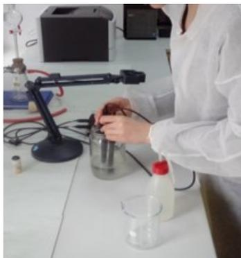
Slika 5 Određivanje pH, vodljivosti i temperature otopine sirutke
