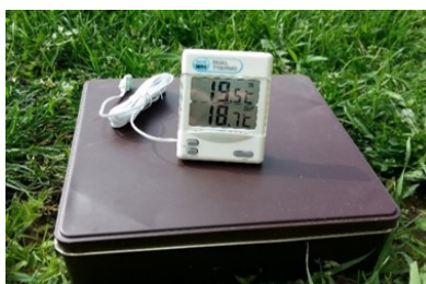
Slika 3 TFA Dotstmann digitalni termometar postavljen na visinskoj podlozi od 10 cm
