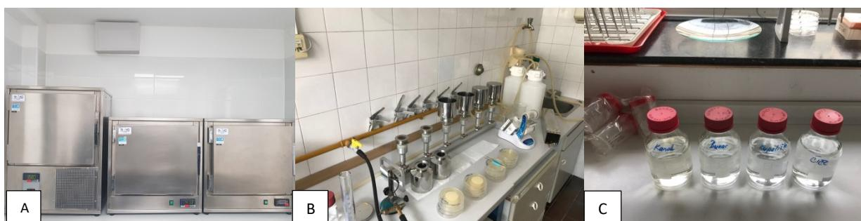
Slika 5. Metodologija: termostat (A), uređaj za membransku filtraciju (B), prikupljeni uzorci (C)
