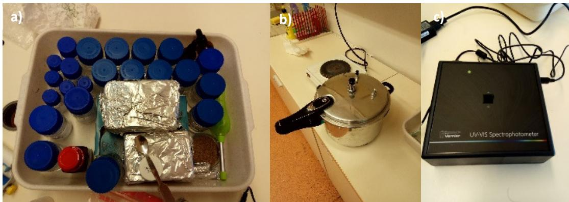
Slika 2 Osnovni pribor za izvođenje istraživanja: a) Sve potrebne otopine i sterilizirani pribor; b) Ekspres Ionac koji je korišten kao autoklav; c) UV/ViS spektrofotometar korišten za mjerjenja apsorbancije
