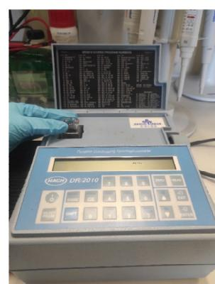
Slika 4 Prijenosni spektrofotometar (HACH DR/2010)
