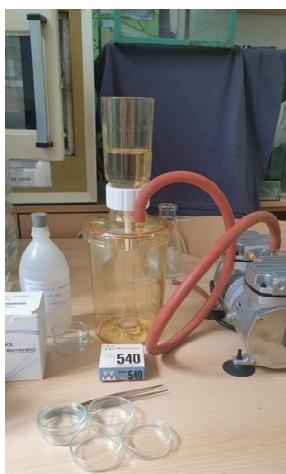
Slika 4 Aparat za filtraciju u školskom laboratoriju s ostalom potrebnom opremom
