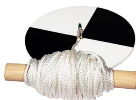
Pomoću užeta, polako spuštajte Secchi ploču u vodu i to do onog trenutka do kojeg se ploča više ne vidi. Nakon toga, izvadite Secchi ploču iz vode te pomoću metra izmjerite duljinu od kraja ploče sve do mokrog dijela užeta. Zabilježite svoj rezultat.
