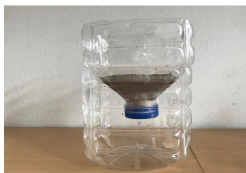
Slika 3 Eksperimentalni postav za mjerenje propusnosti pijeska
