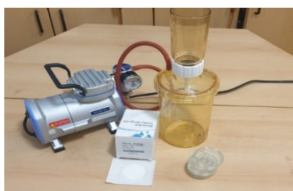
Slika 3 Aparat za filtraciju u školskom laboratoriju s ostalom potrebnom opremom
