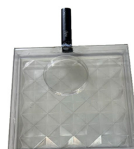
Slika 2 Aparatura za tretiranje podlogama dimom e-cigareta
