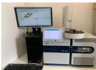
Slika 4 Plinski kromatograf SCION 436-GC
